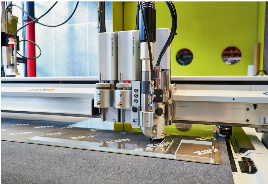
Für die Cutter der G3-Baureihe bietet Zünd Systemtechnik als Option den Werkzeugwechsler ARC (Automatic Router Bit Changer). Der ARC soll ein kontrolliertes Arbeiten mit den Werkzeugen sicherstellen.
