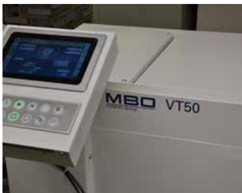
Automatische Qualitätskontrolle mit dem MBO VT50: Zwei Kameras vermessen die Falztoleranzen der fertig gefalzten Bogen.
