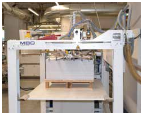
Autonomer Signaturenwechsel: Eine Kamera am Palettenanleger registriert einen auf den Bogen aufgedruckten QR-Code.
