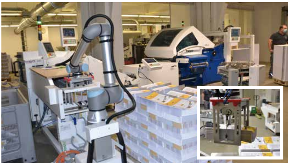
Durchgängig automatisiert bis zum Schluss: Das Absetzen der gefalzten Signaturen übernimmt am Ende der kollaborative Roboter MBO CoBo-Stack.
